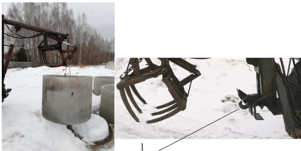
Рис. 3. Фронтальный погрузчик в работе с железобетонными кольцами (1 – Серьга)
