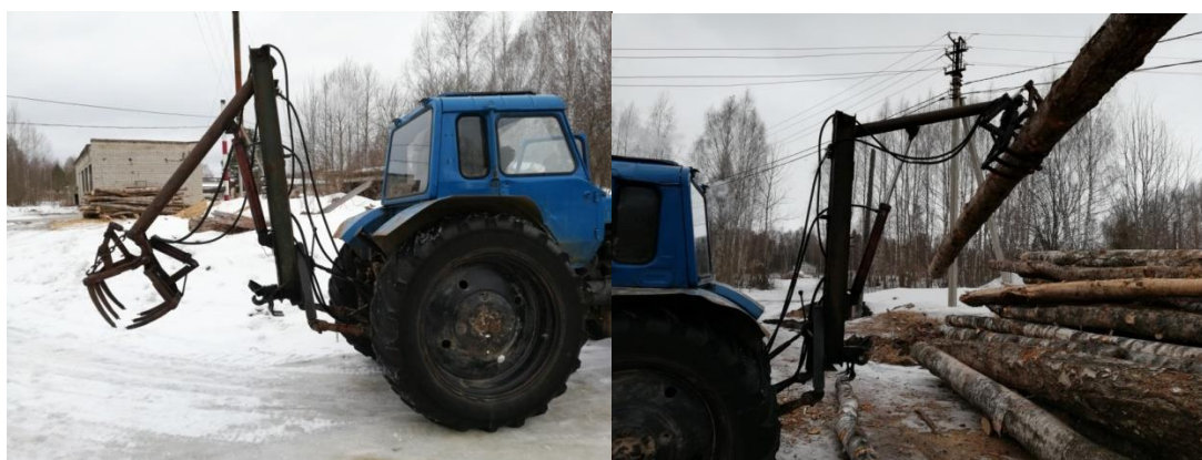
Рис. 2. Фронтальный погрузчик прицеплен и навешен на сцепку трактора МТЗ
