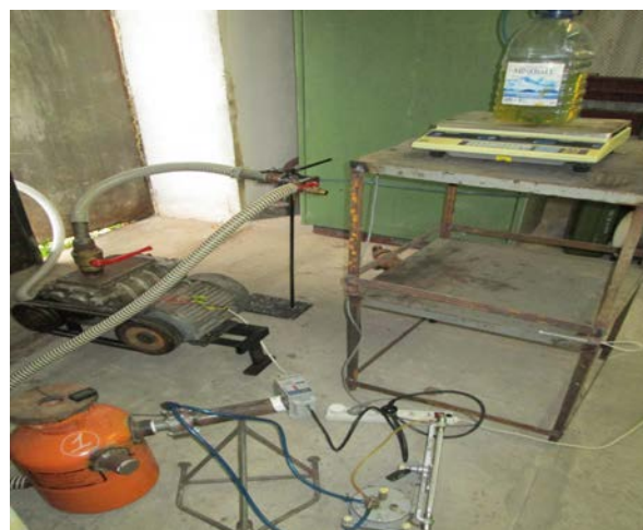
Рис. 2. Лабораторная установка для моделирования режимов работы системы питания ДВС.
