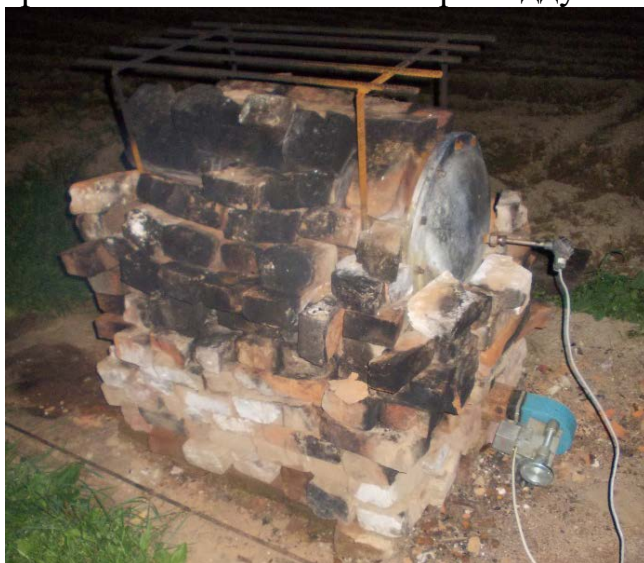
Рис. 3. Общий вид установки в сборе с вентилятором наддува и тармопарой
