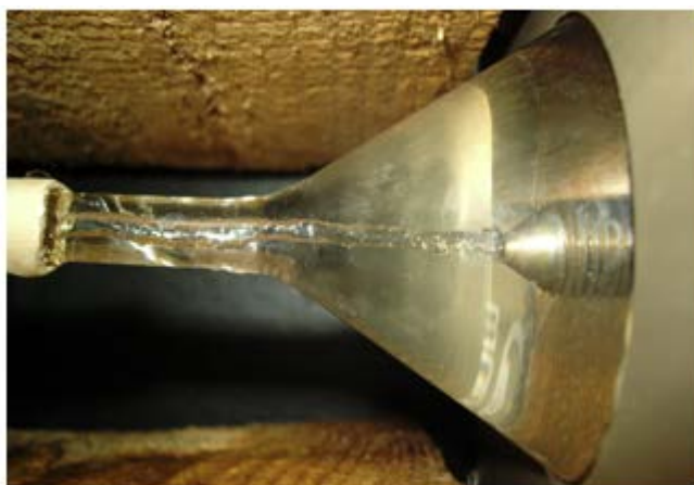
Рис. 6. Фотография реального жидкостного потока при конструктивных параметрах вихревой камеры и граничных условиях потока, принятых в расчетах
