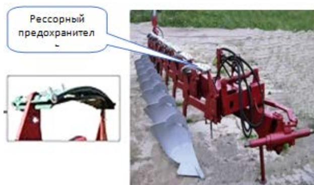
Рис. 3. Плуг ППН.8.30/50 РУП «МТЗ» с рессорными предохранительными устройствами
