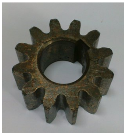
Рис. 2. Применение литого композиционного материала на основе бронзы БрКЗМц1 для изготовления шестерни
