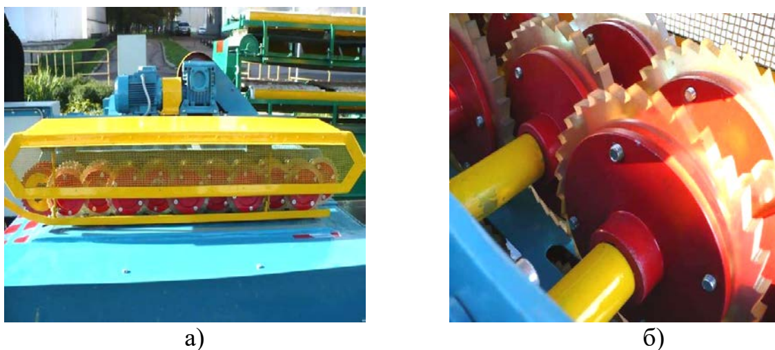
а) Рис. 4. Вид слоеутоняющего механизма СПЛ-2 с эластичными зубьями рабочих дисков: а) сбоку; б) диски рабочие с эластичными зубьями
