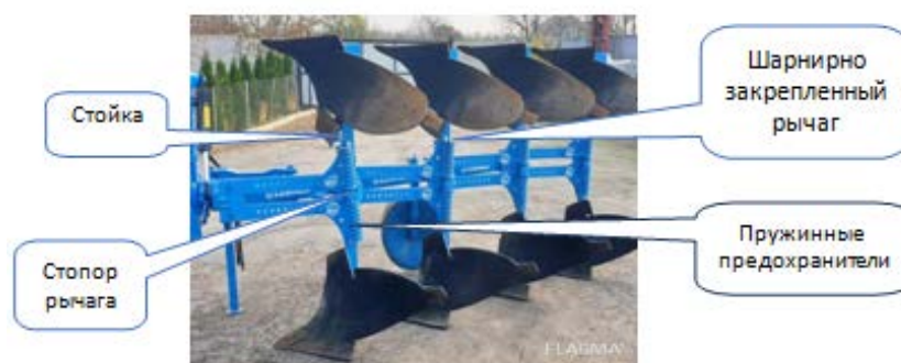
Рис. 4. Плуг оборотный EurOral 110 фирмы Lemken с пружинными предохранительными устройствами
