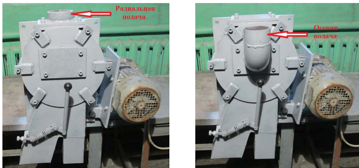
Рис. 1. Общий вид экспериментальной дробилки молоткового типа при радиальной и осевой подаче зернового материала в дробильную камеру. (Шнековый дозатор с приводом и питающий бункер зернового материала демонтированы.)
