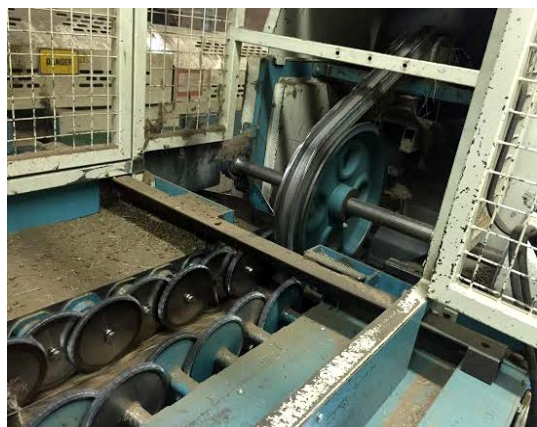
Рис. 1. Общие виды слоеформирующих-слоеутоняющих машин в зарубежных линиях длинного льноволокна: а), б) Depoortere старого образца; в), г) Depoortere нового образца; д), е) Wanhauwaert
