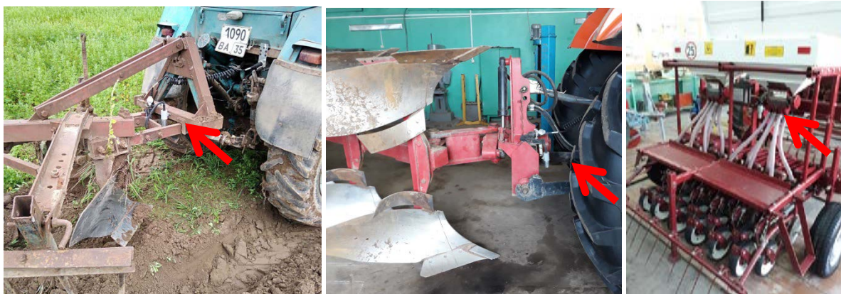
Рис. 2. Монтаж датчиков контроля глубины «Эсорт ДГВ-200» на почвообрабатывающие и посевные агрегаты
