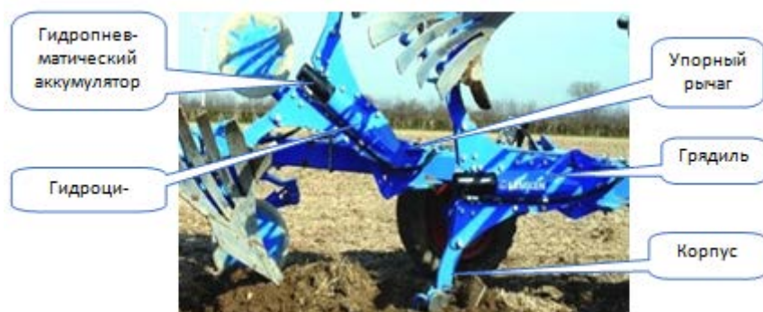
Рис. 2. Плуг Juwel с гидропневматической системой Hydromatic фирмы Lemken
