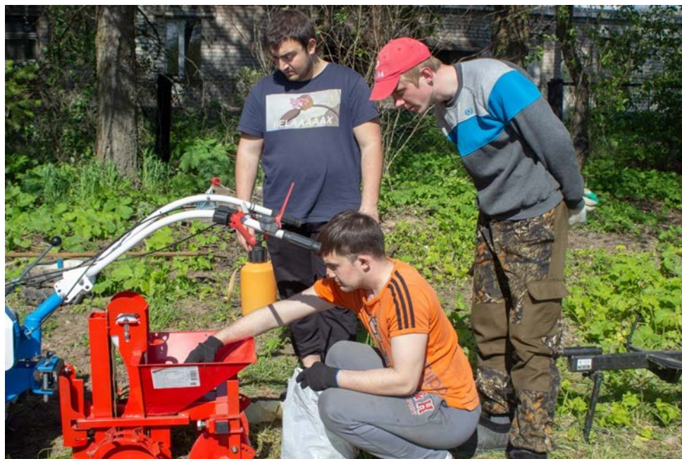
Рисунок 3 - Осмотр комплектующих картофелесажалки для мотоблока
