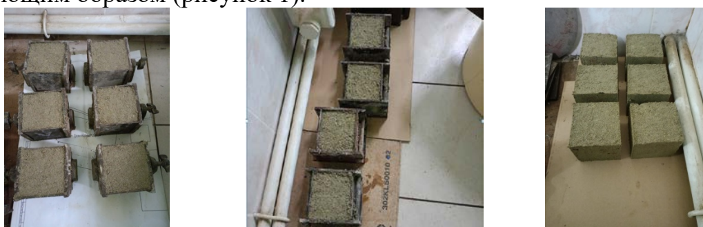
Рисунок 1 – Образцы опилкобетона из опилок пихты
