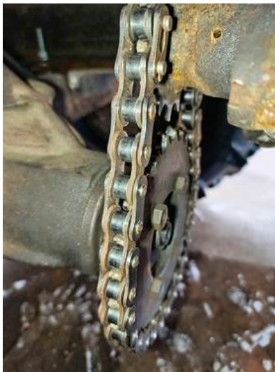
Рисунок 5 – Передача крутящего момента от КПП к заднему мосту
