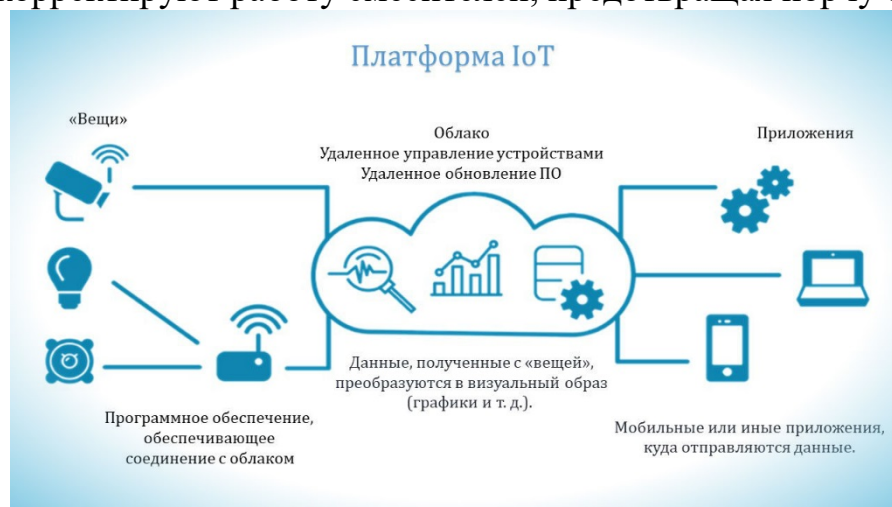
Рисунок 1 – Принцип работы IoT-системы
