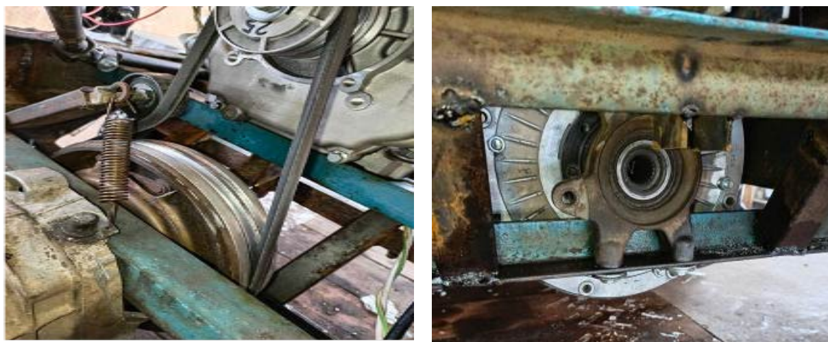
Рисунок 4 – Передача крутящего момента от двигателя к КПП
