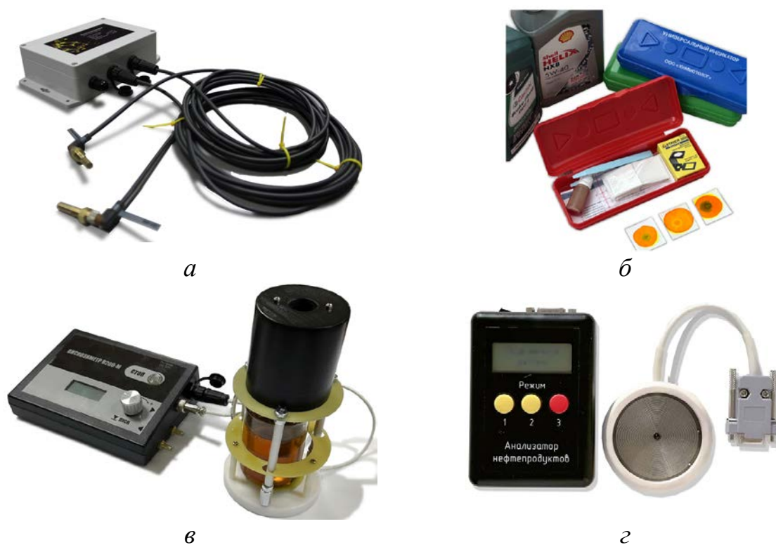
Рисунок 1 – Приборы и средства для контроля показателей качества моторных масел компании «Химмотолог»:
