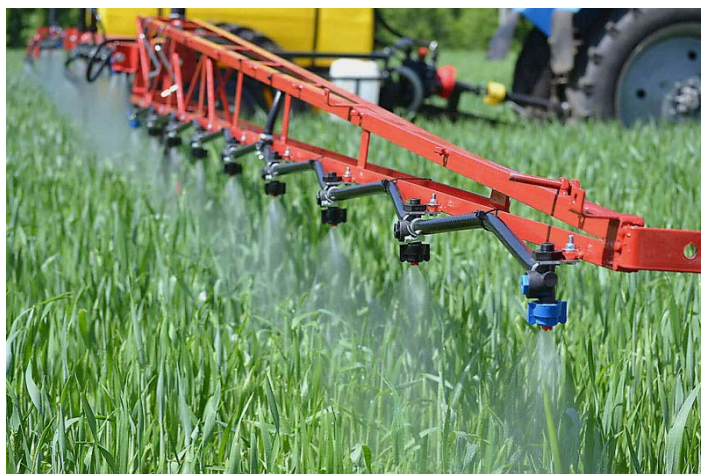
Рисунок 2 – Положение штанги опрыскивателя над растениями
