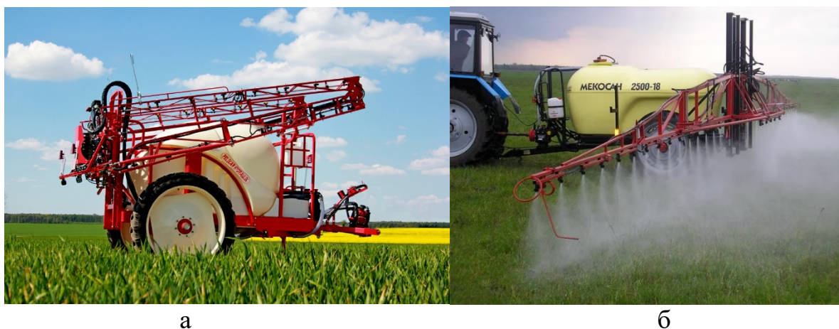
Рисунок 1 – Штанговый опрыскиватель а – транспортное положение, б – рабочем состоянии
