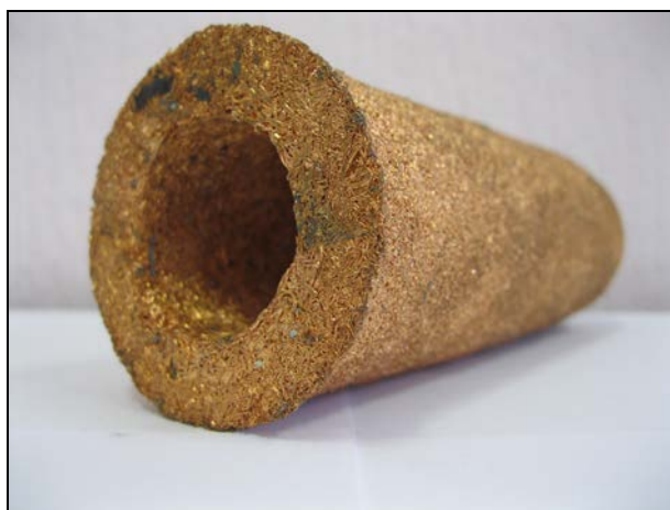
Рис. 2. Внешний вид двухслойного волокнистого фильтрующего элемента
