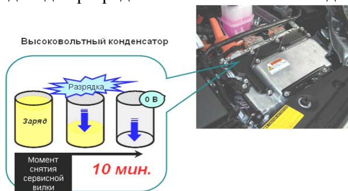
Рис. 2. Разряд высоковольтных конденсаторов
