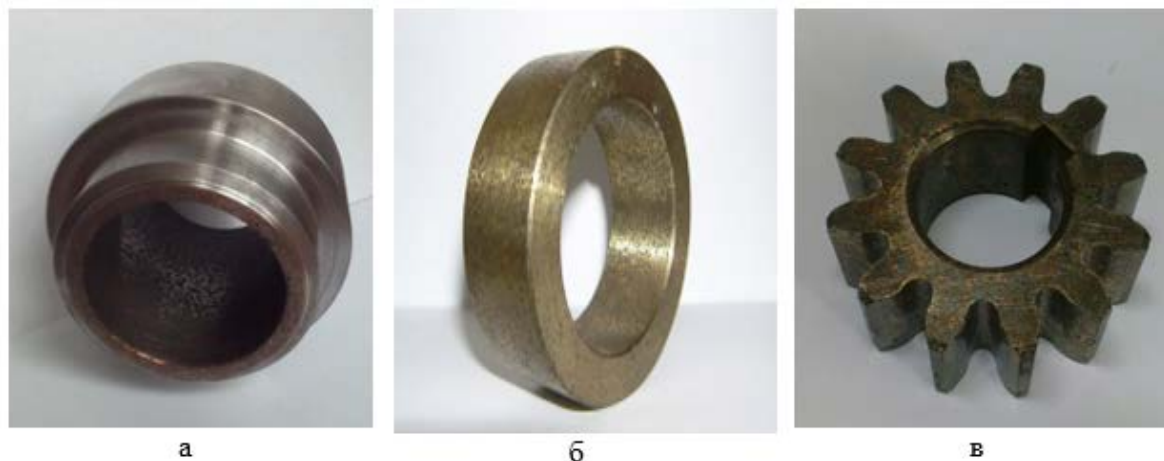
Рис. 1. Применение литого композиционного материала на основе бронзы БрКЗМц1с: а) втулка износостойкая для двигателя Д-240; б) подшипник скольжения тракторного прицепа ПСС-25; в) шестерня механизма управления автомобиля ГАЗ -53
