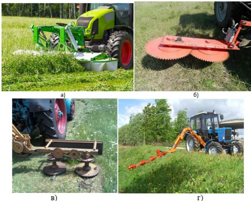
Рис. 1. Способы установки роторных косилок к трактору
