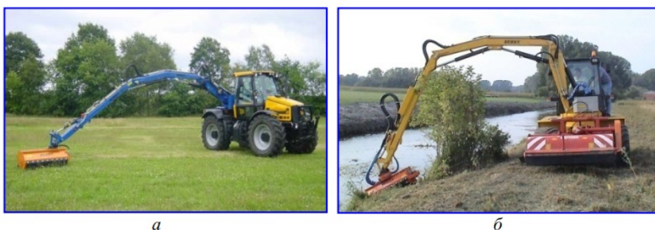
Рис. 4. Косилки-измельчители с рабочими органами: а – на поворотной платформе; б – навешенными фронтально и на поворотной колонке
