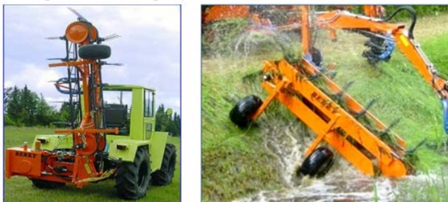
Рис. 2. Общий вид цепного подборщика: а – в транспортном положении; б – в рабочем положении
