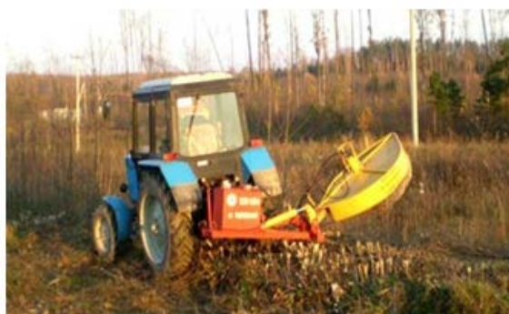
Рис. 3. Однороторная четырехножевая косилка КР-1: 1 – верхняя часть кожуха; 2 – гидроцилиндр; 3 – шланги; 4 – рукоять; 5 – верхняя часть кожуха; 6 – защитная дуга; 7 – дренажный шланг; 8 – ограждение; 9 – гидромотор; 10 – зубчатые ножи; 11 – ротор; 12 – задняя часть кожуха; 13 – цепной фартук
