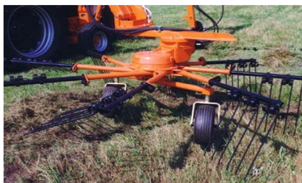
Рис. 3. Роторный рабочий орган с гидроприводом подборщика срезанной растительности
