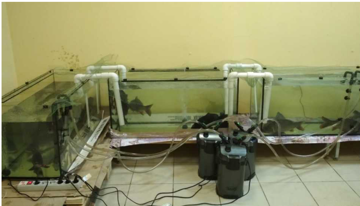
Рисунок 1 — Экспериментальная установка с обеспечением непрерывной циркуляции воды
